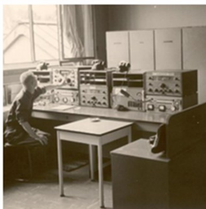
Operatorstanden telefonie links met ontvanger Racal RA17, rechts met ontvanger RCA CR91
