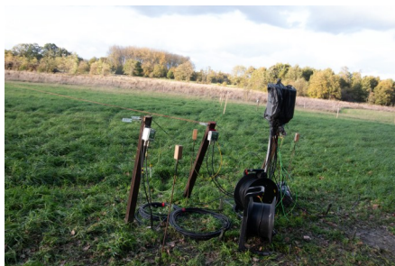
160m en 80m beverage antenne
